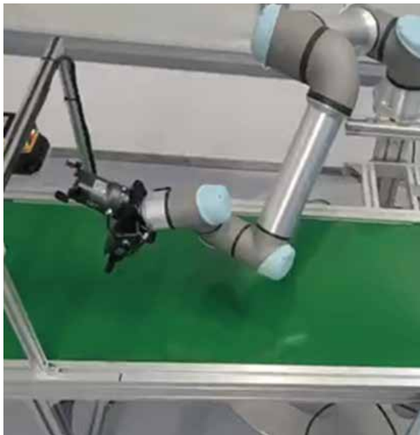
PGC-50-35 工厂自动化 双爪搭配协作机器人，完成流水线上下料
