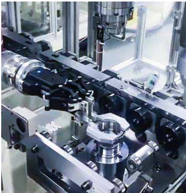
AG-160-95 汽车零部件 搭配协作机器人完成滚针轴承夹取及组装任务
