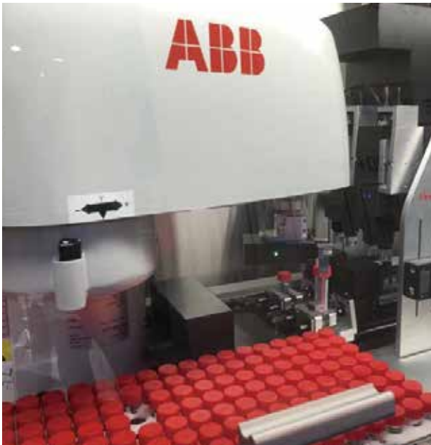
RGI-35-14 医疗自动化 自动化分杯处理系统，夹爪抓取移送试管至指定位置，旋转开盖，提取后自动合盖并安全归位
