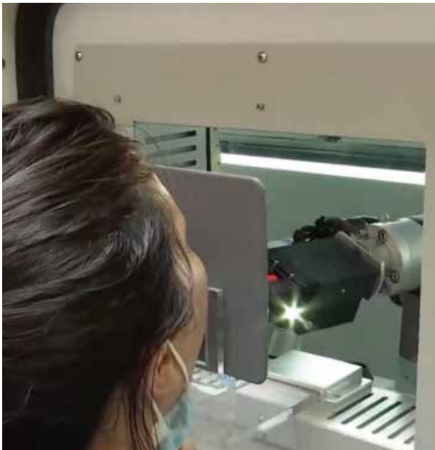
PGE-15-26 医疗自动化 咽拭子采样机器人，在无医护人员的情况下独立完成采样步骤
