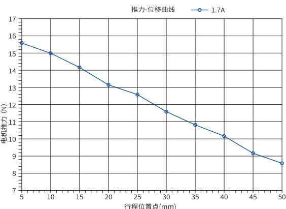
\*① 无保护弹簧时电机出力；
