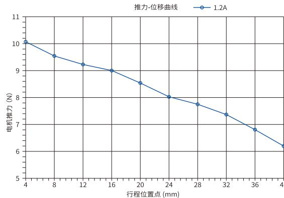
\*① 无保护弹簧时电机出力;
