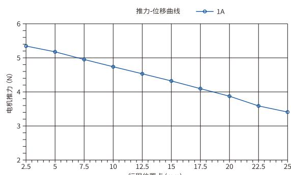
\*① 无保护弹簧时电机出力；
