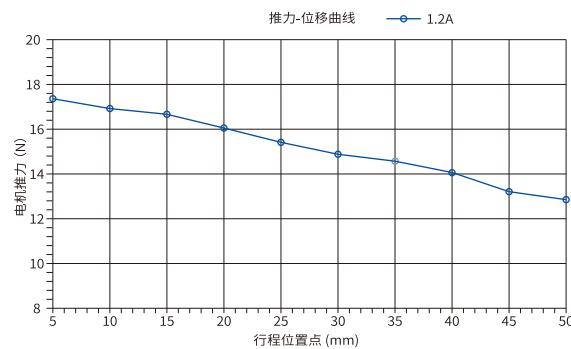
\*① 无保护弹簧时电机出力；
