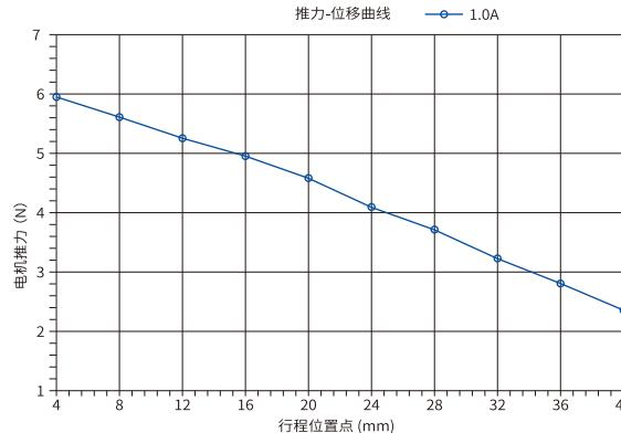
\*① 无保护弹簧时电机出力;
