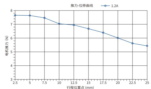
\*① 无保护弹簧时电机出力；
