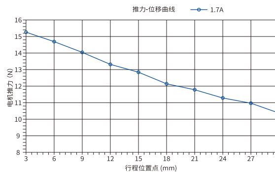
\*① 无保护弹簧时电机出力；
